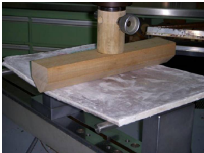
Figuras 1 y 2. Aplicación de ensayo a la flexotracción
