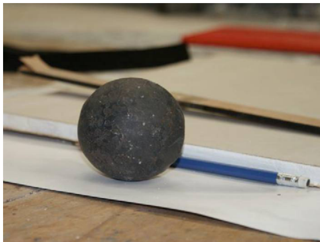
Foto 3. Bola de acero usada en el ensayo
